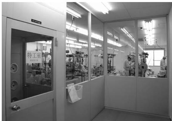
特殊精密打ち抜き加工工程（クリーンルーム）
